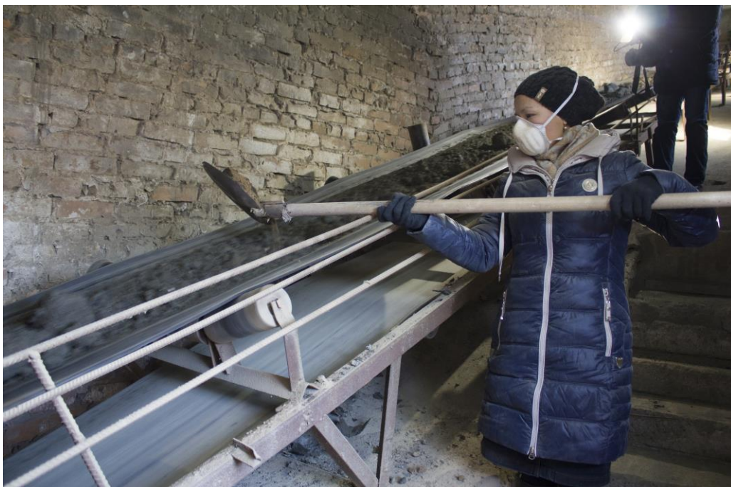
Процесс внедрения конгломератной смеси с добавлением нефтешлама в технологическую линию
