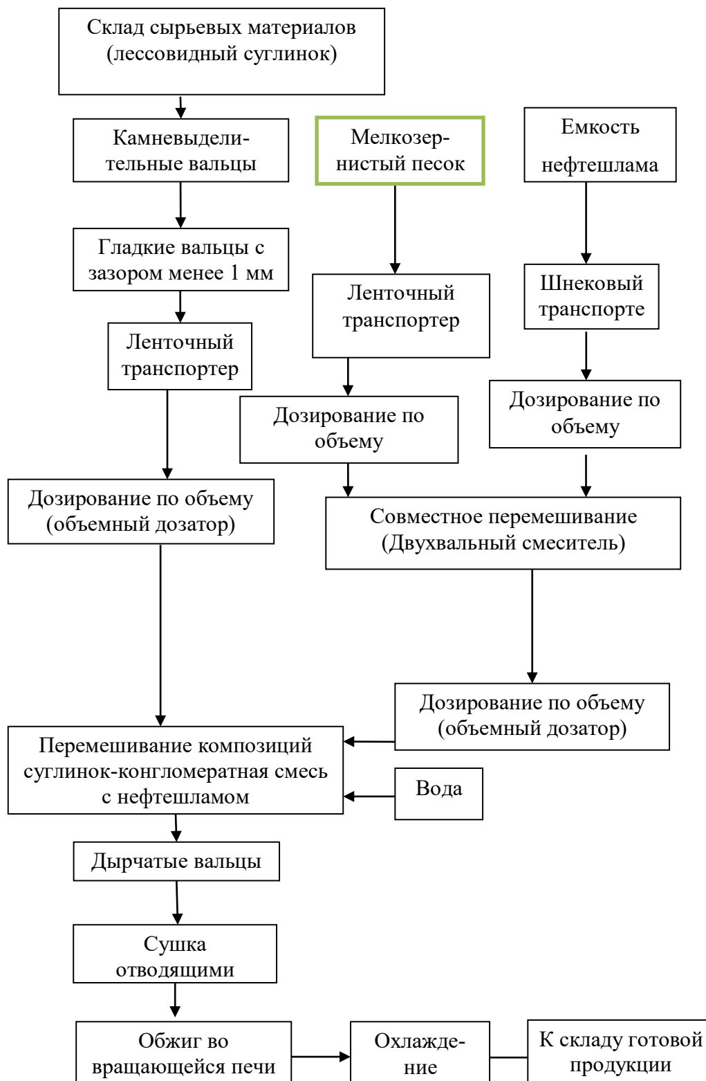
Рисунок 85 – Технологическая схема производства керамзита с применением лессовидного суглинка и конгломератной добавки в 2х системах
