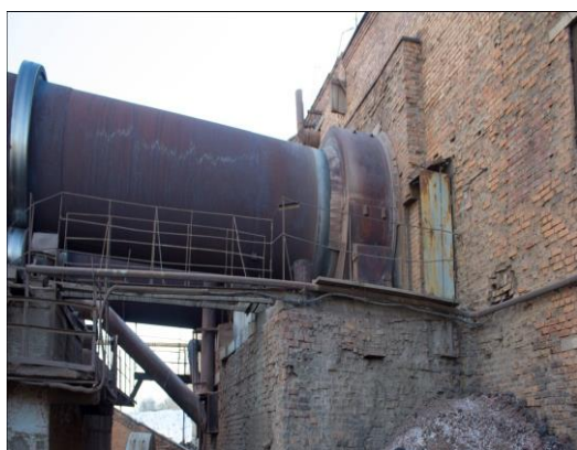
Рисунок 84 – Процесс обжига керамзита во вращающейся печи на предприятии ТОО «Стройкомбинат»
