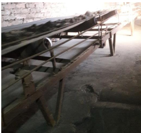
Рисунок 83 – Процесс введения конгломератной смеси в технологическую линию на ленточном конвейере
