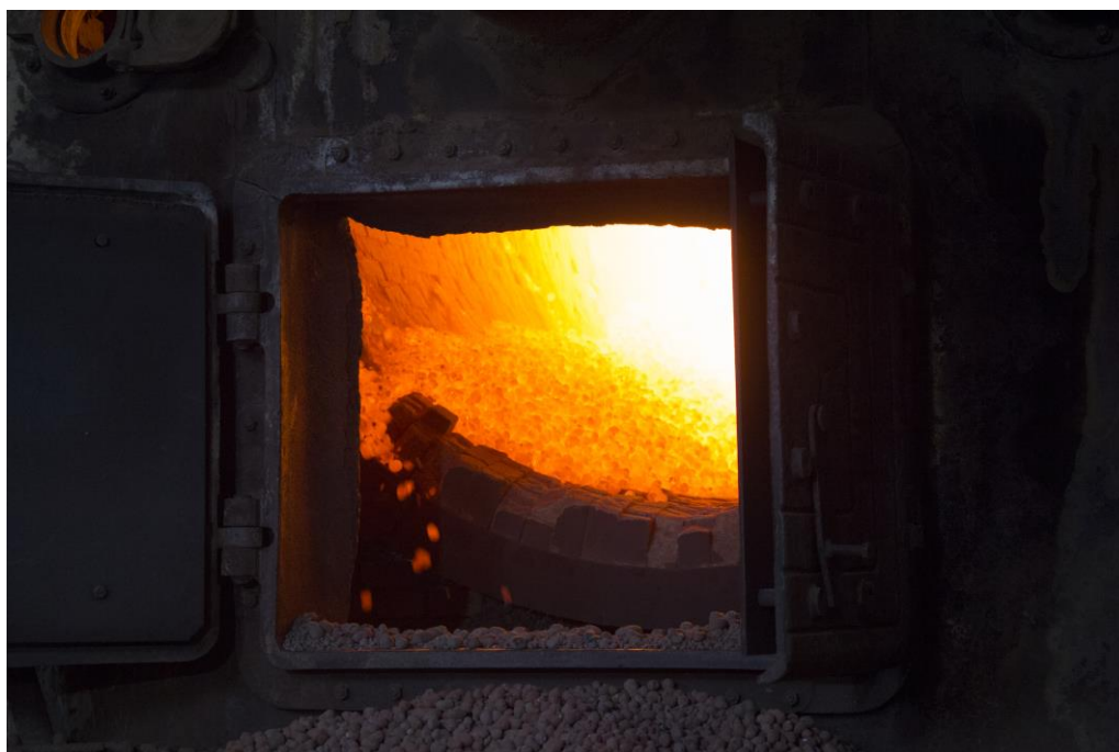
Процесс обжига керамзита во вращающейся печи
