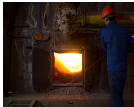
Рисунок 84 – Процесс обжига керамзита во вращающейся печи на предприятии ТОО «Стройкомбинат»
