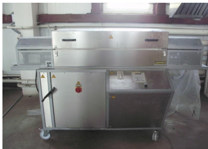
Рисунок 12 – Лабораторная вращающаяся печь RSR120/1000/13
