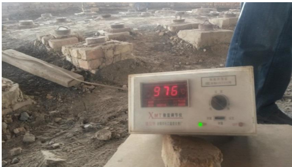
Рисунок 88 – Показания термопары заводской кольцевой печи
