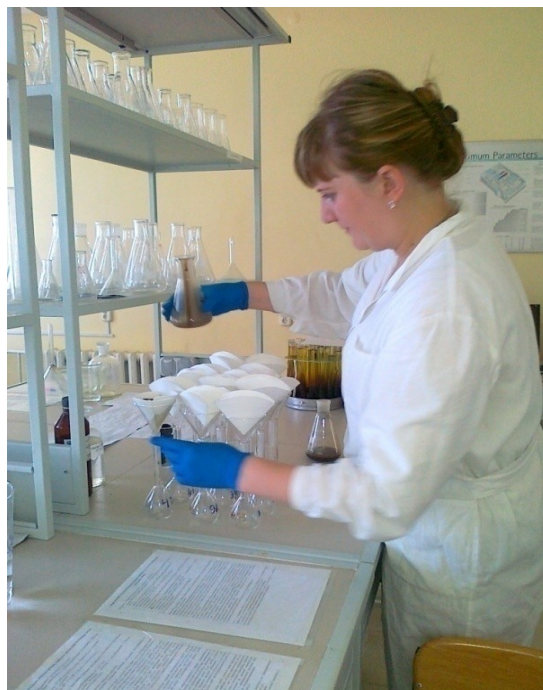
Рисунок 1, 2 – Проведение опыта в лаборатории НИИ ЗКАТУ имени Жангир хана (добавление к воздушно-сухой почве раствора азотной кислоты 1:1 и фильтрация почвенных образцов после остужения)
