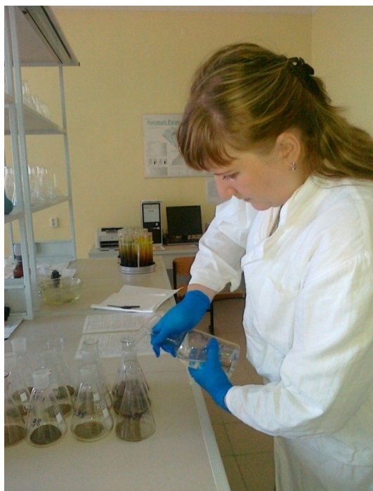
Рисунок 1, 2 – Проведение опыта в лаборатории НИИ ЗКАТУ имени Жангир хана (добавление к воздушно-сухой почве раствора азотной кислоты 1:1 и фильтрация почвенных образцов после остужения)
