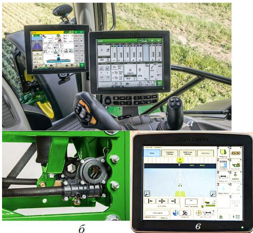
Сурет 4.20 – Дәлдік (AMS) егіншілік жүйелерінің мониторы: а – тұқымдардың себілуін бақылау; б – RowCommand жүйесіндегі Pro-Shaft жетегі; в – монитор
