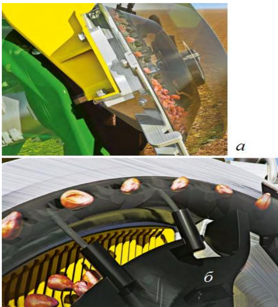
Сурет 4.16 – Себу аппараттарындағы электромоторлар және щеткалы айырғыш.
