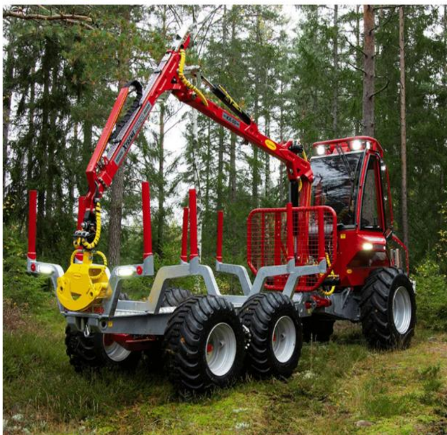
Сурет 3.5 – Доңғалақты harvester 1270G және шағын forwarder 960
