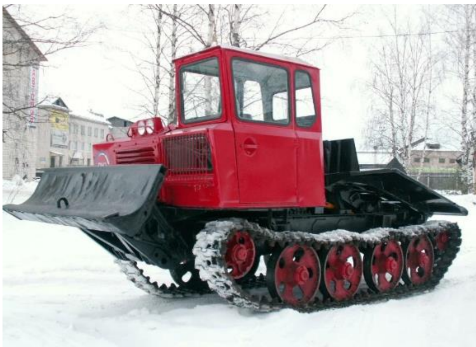
Сурет 3.13 – Кепкен бұтақтарды жинайтын ПС-2,4 машинасы
