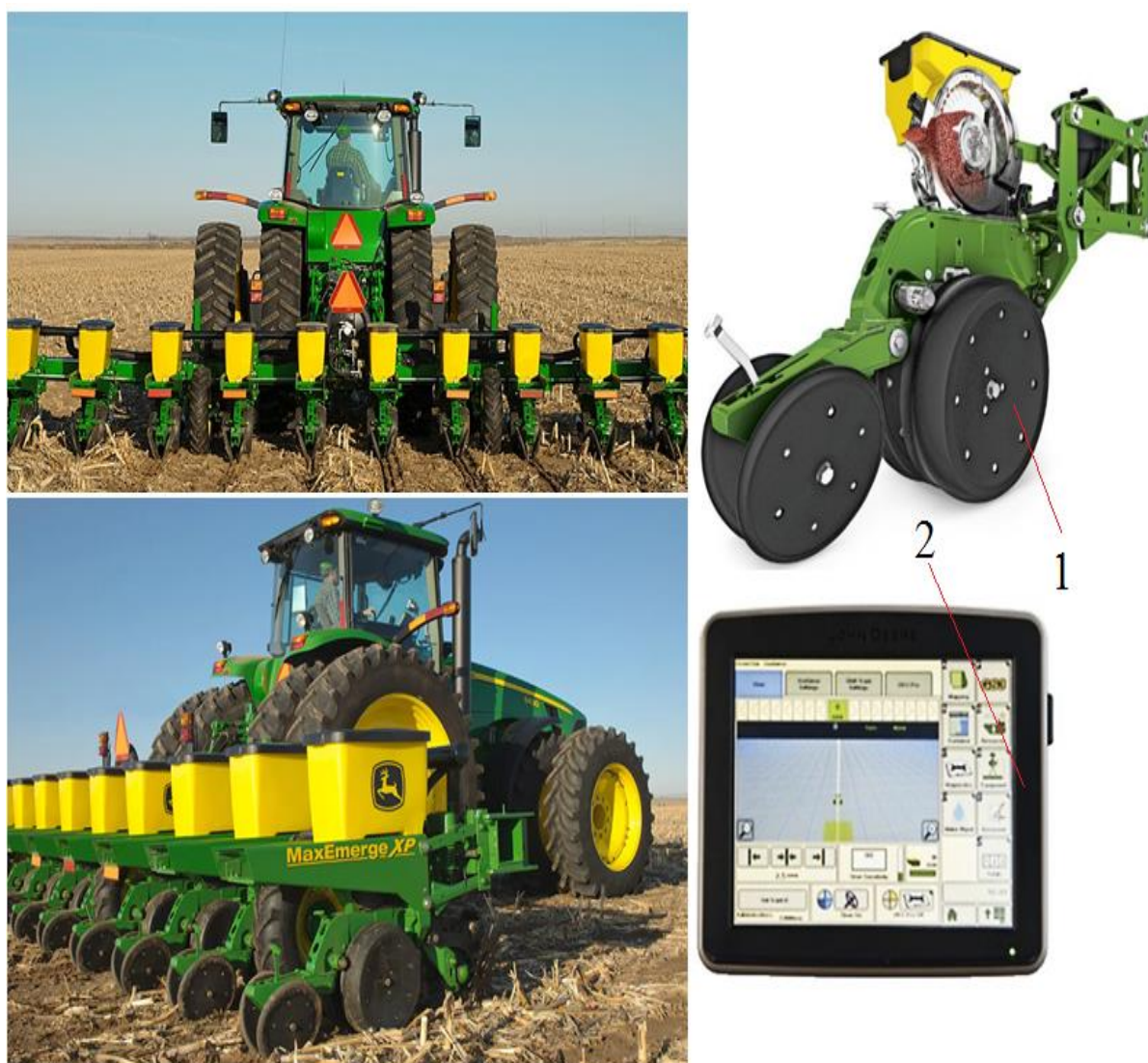
Сурет 2.15 – Дәлдікпен егетін 1715 John Deere сепкіші: 1 – сепкіш секция MaxEmerge 5; 2 – дәлдік егіншілік жүйесінің барлық қосымшаларына арналған монитор – SeedStar 2 мониторинг жүйесі.
