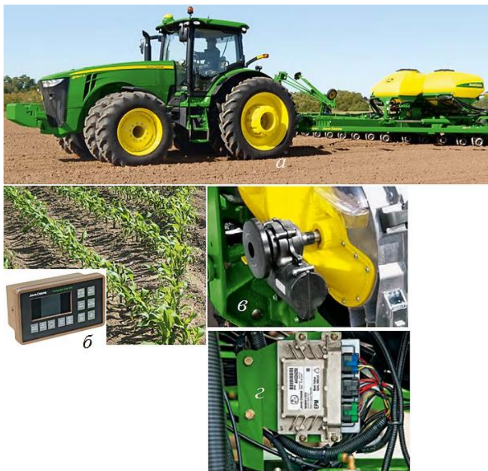
Сурет 4.19 – Секцияларды басқару RowCommand жүйесі: а – тұқым себу кешені; б – COMPU TER-TR АК дисплейі; в – Pro-Shaft жетек редукторы; г – электрондық қоректендіру блогы.
