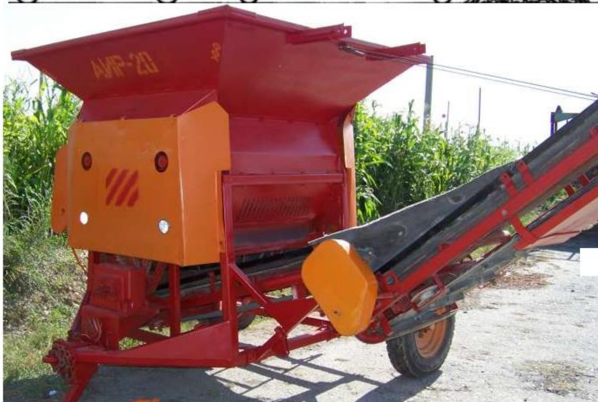
Сурет 2.2 – Тыңайтқыш қапталған қаптарды босатуға және тыңайтқышты ұсақтауға арналған АИР-20 агрегаты: 1 – бункер; 2 – салғыш; 3 – барабандар; 4 – қарсы кескіш пластина; 5 – ажырату құрылғысы; 6 – босатушы құрылғының тістері; 7 – түсіретін транспортер.
