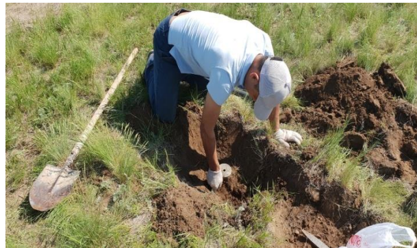
Сурет 2 - «Атамұра» шаруа қожалығында топырақ тығыздығын анықтау
