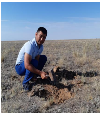
Сурет 19 - «Мирас» шаруа қожалығында ашық қара-қоңыр топырақтың тығыздығын анықтау сәті
