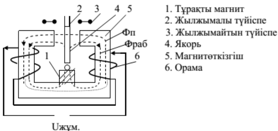
3.6-сурет. Поляризацияланған реле құрылғысы және әрекет принципі
