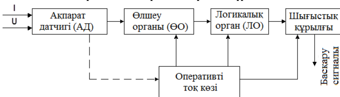
1.6-сурет. Релелік қорғаныс құрылғыларының жалпы құрылымы
