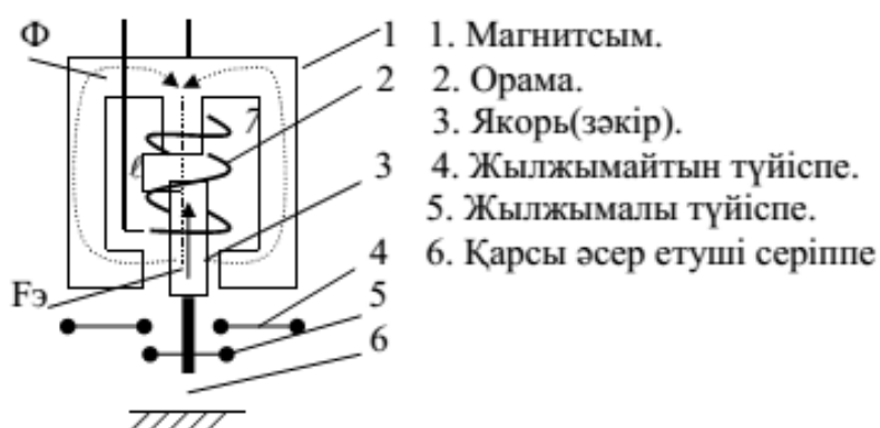
3.1-сурет. Тартқыш зәкірі бар реле
