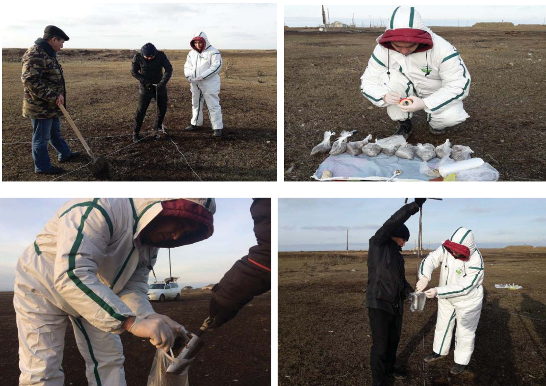
1-сурет. Әр түрлі учаскелерден топырақ сынамаларын алу және орау
