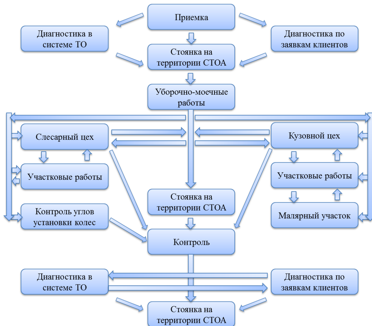
Рисунок 4.6 – Организация технологического процесса ТО и ТР на СТОА
