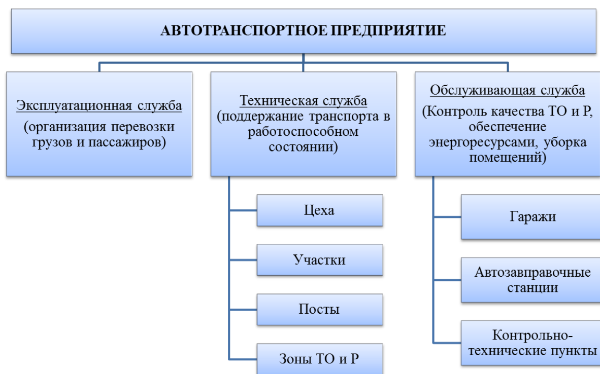
Рисунок 1.4 – Службы автотранспортного предприятия обеспечивающие выполнение технологических процессов
