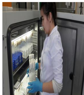
В) Климатическая камера 20-24 0 С, освещенность 8 ± 2 тыс. люкс, фотопериод 16 часов, влажность 70 %
