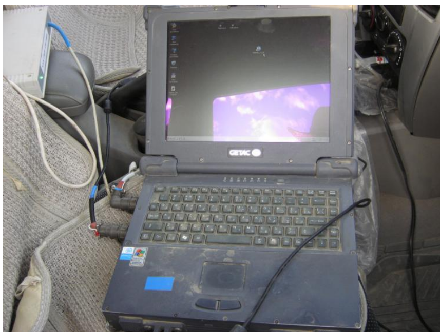
Рисунок 2 - Микросейсмическая инфразвуковая станция на базе защищённого ноутбука Getac-790
