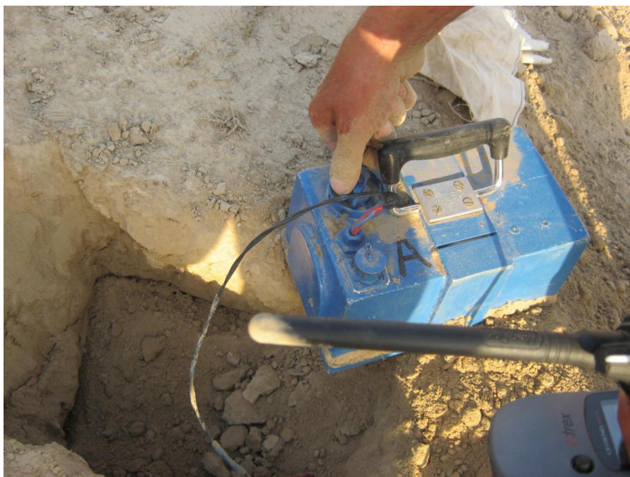
Рисунок 1 -Наземная регистрирующая установка АНЧАР–Гео-7
