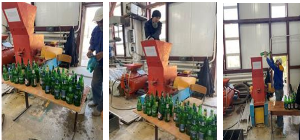
Рисунок 2.3 – Технологический процесс дробления и измельчения стекlobоя
