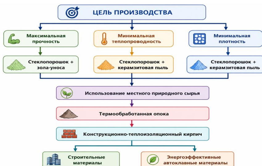
Рисунок 7.5 – Концепция выбора рациональной композиционной системы в зависимости от требуемых эксплуатационных свойств силикатного кирпича
