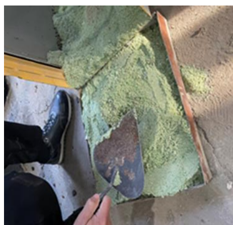
Рисунок 2.5 - Процесс забора первично дробленного стеклобоя из нижней приемной металлической ёмкости молотковой дробилки.
