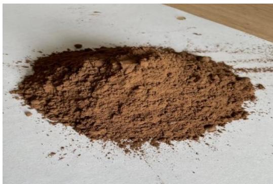
Рисунок 5.1 – Общий вид керамзитовой пыли, образующейся на ТОО «СТРОЙКОМБИНАТ»
