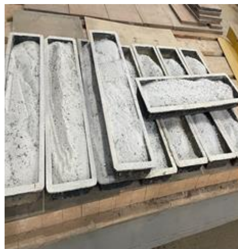
Рисунок 2.9 – Полученный тонкодисперсный стеклопорошок для введения в силикатную массу
