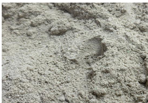
Рисунок 2.10 – Компонентная смесь в системе «силикатная масса – стеклопорошок»
