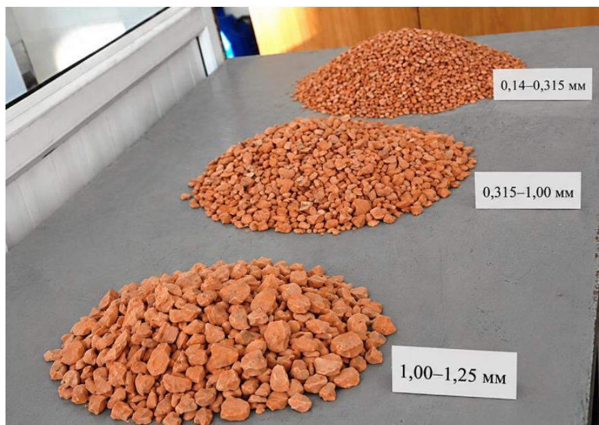
Рисунок 6.2 – Фракционный состав термообработанной опоки размером 0,14–1,25 мм.
