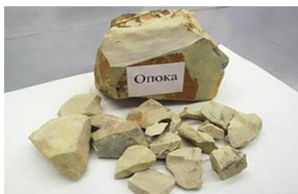
Рисунок 6.1 – Общий вид исходной и термообработанной опоки Таскалинского месторождения.
