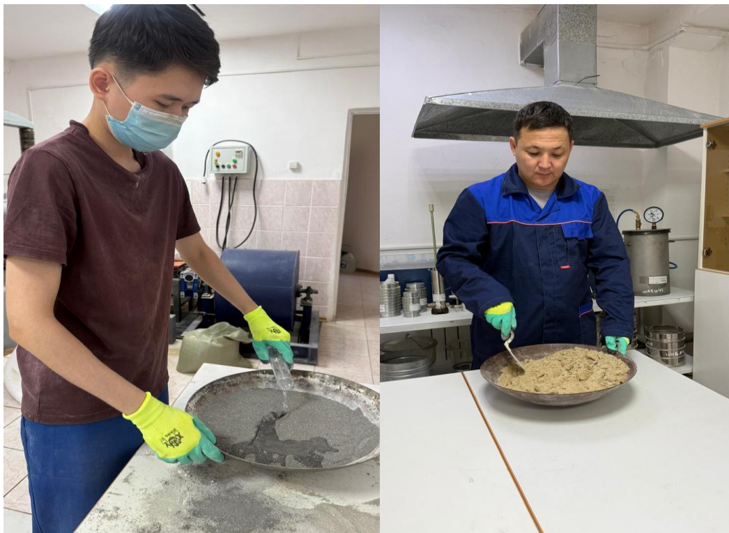
Рисунок 2.12 – Подготовка компонентов и приготовление силикатной массы
