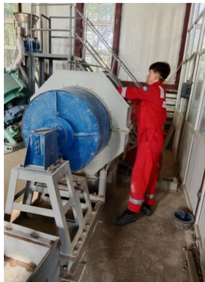
Рисунок 2.8 – Процесс помола стеклобоя на шаровой мельнице марки МШЛ 300
