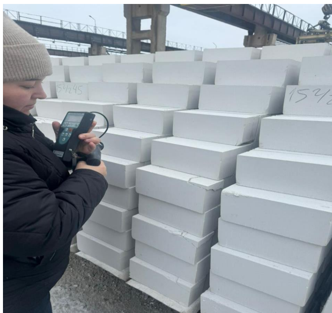
Рисунок 7.7 – Общий вид опытного силикатного кирпича после автоклавной обработки
