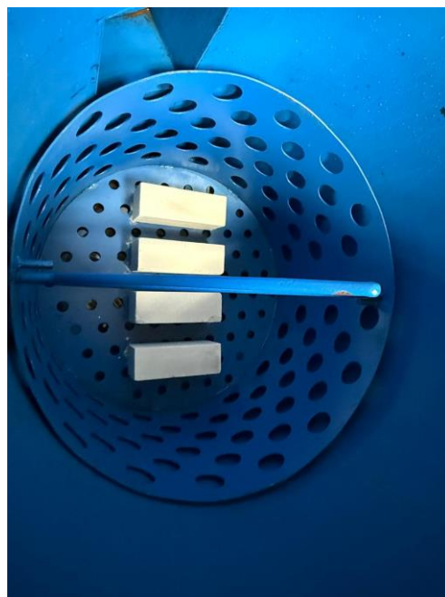
Рисунок 2.13 – Автоклавная обработка экспериментальных образцов
