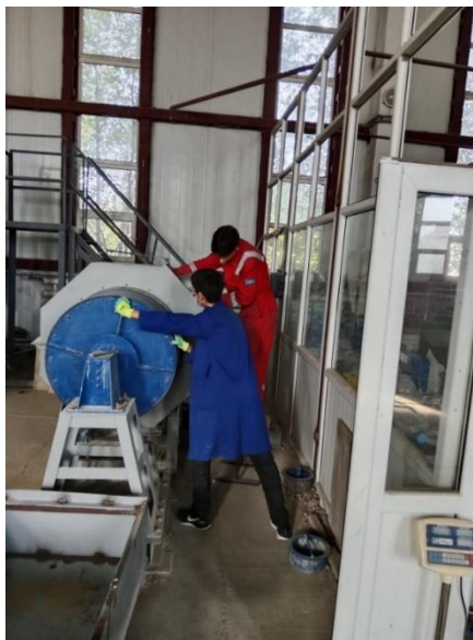
Рисунок 2.8 – Процесс помола стеклобоя на шаровой мельнице марки МШЛ 300
