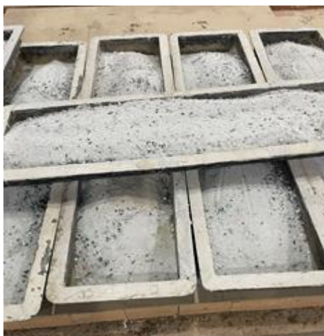
Рисунок 2.9 – Полученный тонкодисперсный стеклопорошок для введения в силикатную массу
