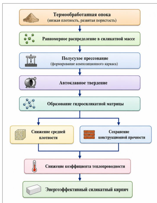
Рисунок 6.4 – Концептуальная схема структурообразования силикатного кирпича с использованием термообработанной опоки
