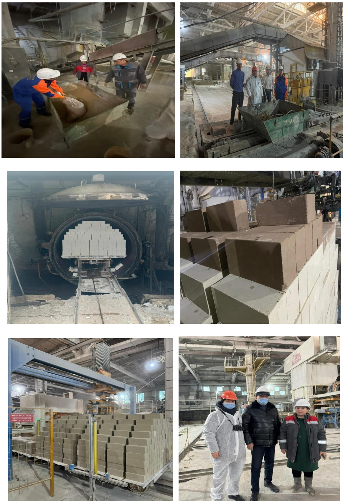
Рисунок 7.1 – Основные технологические операции опытно-промышленного изготовления силикатного кирпича на производственной базе АО «ЗККСМ»
