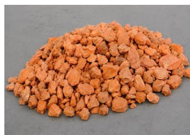
Рисунок 6.1 – Общий вид исходной и термообработанной опоки Таскалинского месторождения.
