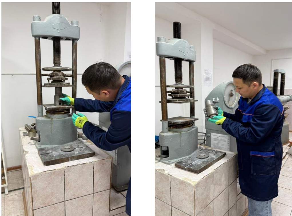
Рисунок 2.12 – Формование экспериментальных образцов силикатного кирпича
