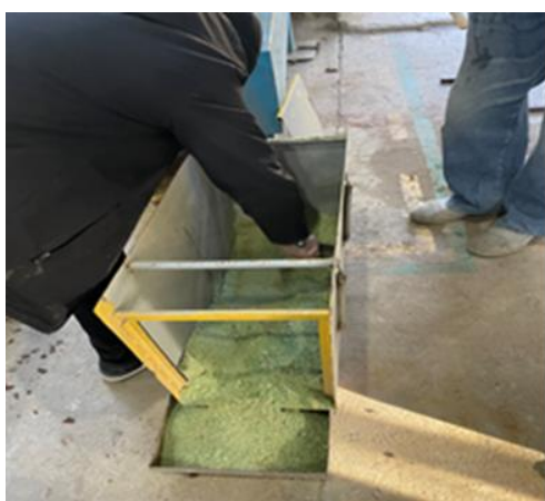
Рисунок 2.5 - Процесс забора первично дробленного стеклобоя из нижней приемной металлической ёмкости молотковой дробилки.
